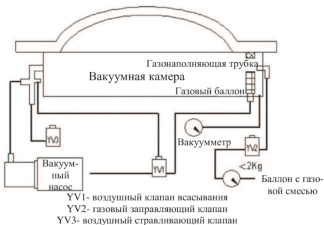
Схема вакуумного упаковщика с системой газации
